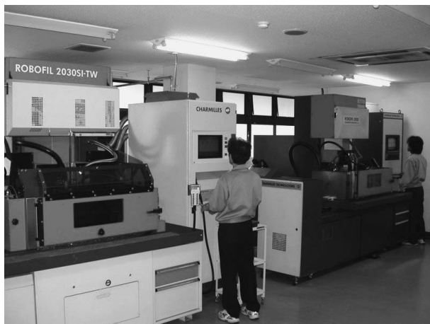
超高精度ワイヤ放電加工機 も早い時期に装備した金型 加工現場
